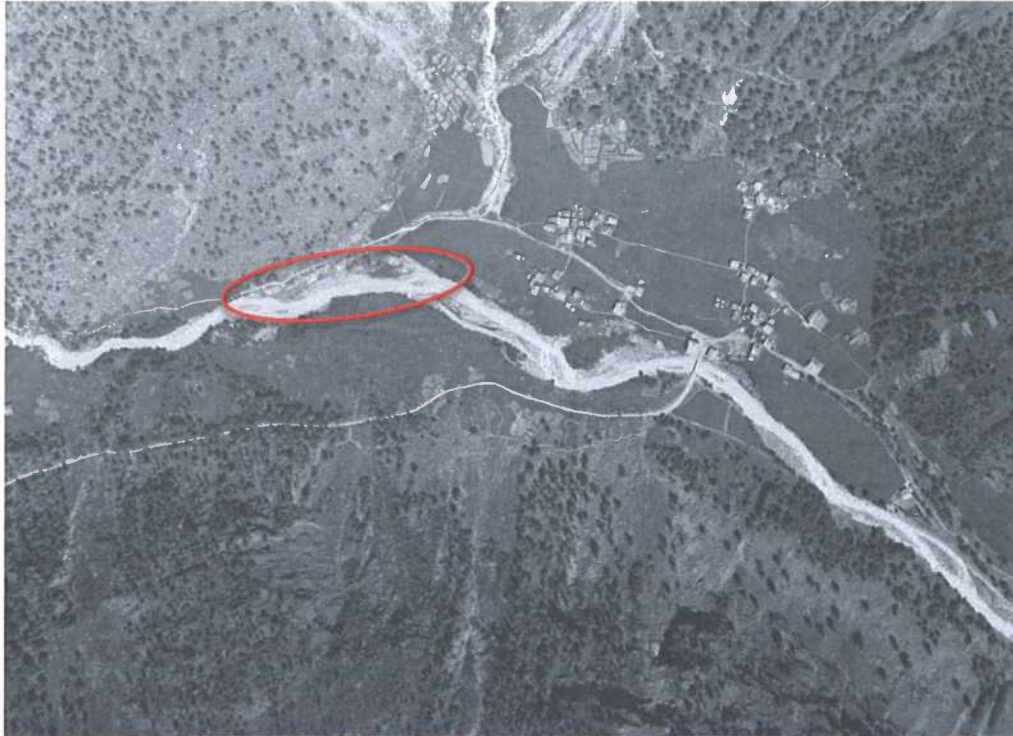
Abbildung 1: Historisches Luftbild von Saas-Almagell aus dem Jahr 1936 (Quelle swisstopo). Das Luftbild zeigt, dass sich die Saaservispa natürlicherweise im Bereich "Einmündung Almagellerbach" ausdehnte (Geschiebeablagerung) (rot markiert). Deshalb gilt es in diesem Gebiet, sofern möglich, einen breiteren Gewässerraum auszuscheiden um den für eine allfällige spätere Revitalisierung erforderlichen Raum frühzeitig zu reservieren. Des Weiteren gilt die Flachstrecke Almagellerbach als Revitalisierungsstrecke. Hier wird auf die Vorstudie "Hochwasserschutzmassnahmen Almagellerbach: Variantenvergleich" verwiesen.
