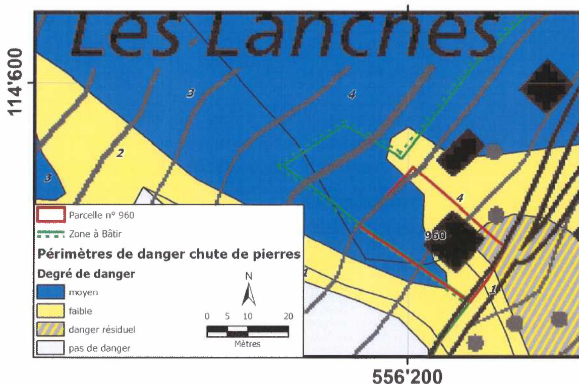
Figure 3 : Situation de danger liée aux chutes de pierres sur la parcelle n°960.
