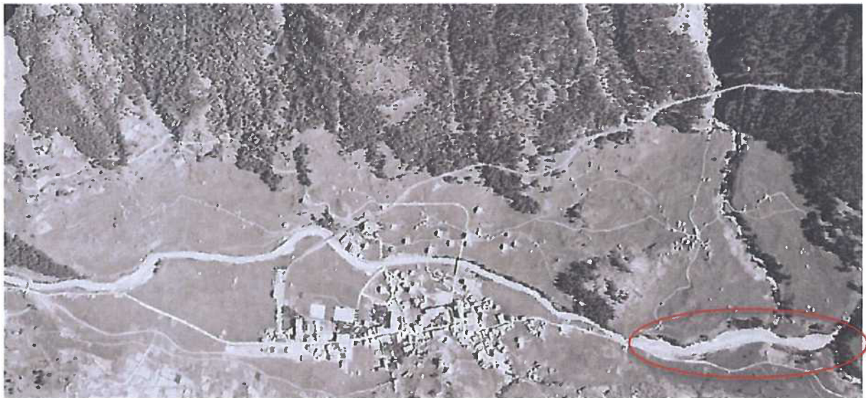
Abbildung 1: Historisches Luftbild von Zermatt aus dem Jahr 1941 (Quelle swisstopo). Das Luftbild zeigt, dass sich die Vispa natürlicherweise einzig im Bereich "Zen Stecken" ausdehnte (Geschiebeablagerung) (rot markiert). Deshalb gilt es in diesem Gebiet, sofern möglich, einen breiteren Gewässerraum auszuscheiden um den für eine allfällige spätere Revitalisierung erforderlichen Raum zu reservieren.
